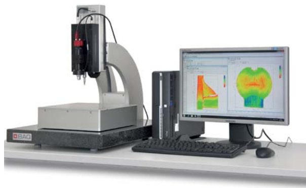
Abbildung 6: UCI-Flächenmessung mit dem UT200
