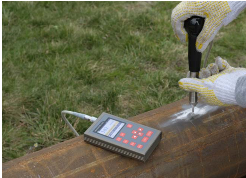
Abbildung 3: mobile Härteprüfung mit dem alphaDUR mini
