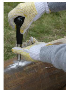
Fig. 13: Manico della sonda
