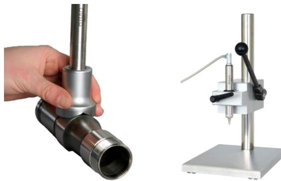
Fig. 14: Gestione semplificata grazie al supporto della sonda (sx) e supporto ad alta precisione (dx)
