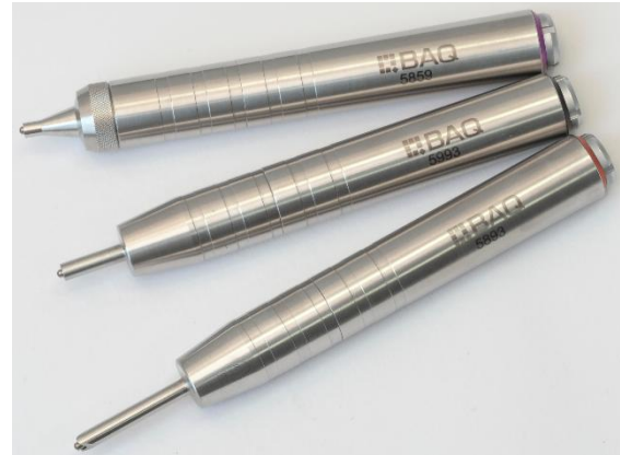
Abbildung 3: Standard UCI-Prüfsonde (oben); SL-Sonde (Mitte); SL-L-Sonde (unten)
