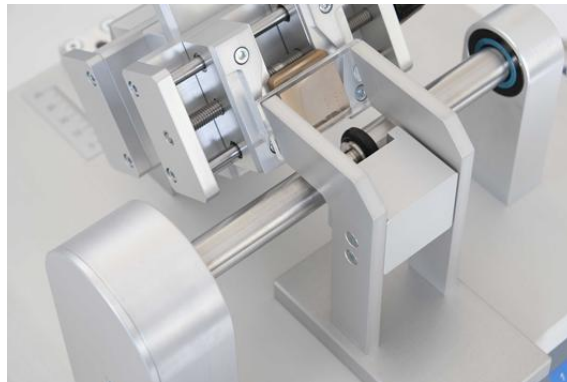
Abbildung 16: Verwendung der Einstelllehre (hier mit Adapter)
