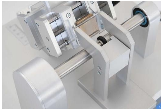
Abbildung 14: Verwendung der Einstelllehre (hier: inkl. Adapter für 0,2N)
