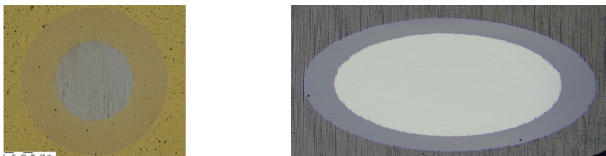
Abbildung 3: Kalotten auf ebener (links) und zylindrischer Probe (rechts)
