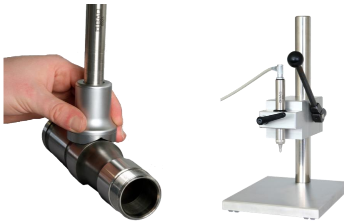
Abbildung 14: Verwendung von Aufsetzhilfe (links) und Präzisionsmessstativ (rechts)
