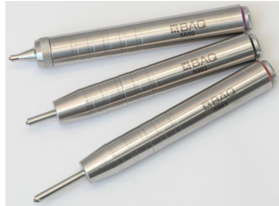
Abbildung 3: Standard UCI-Prüfsonde (oben); SL-Sonde (Mitte); SL-L-Sonde (unten)
