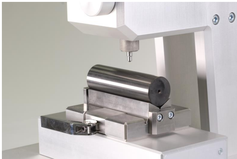
Abbildung 8: Prisma zur Aufnahme zylindrischer Proben
