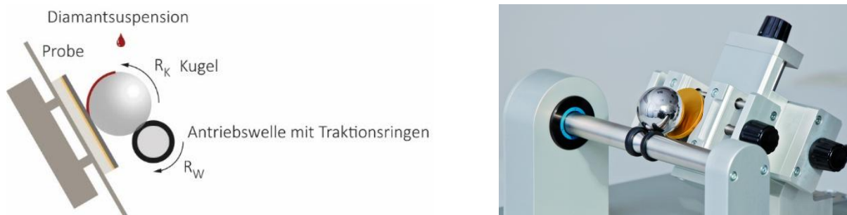
Abbildung 2: Messprinzip Kalottenschliff
