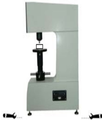
Abbildung 3-4 Einnivellieren des Gerätes
