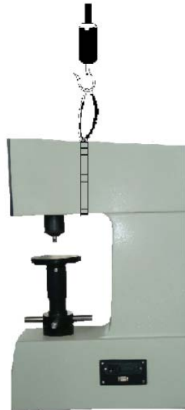
Abbildung 3-2 Anheben des Messgerätes
