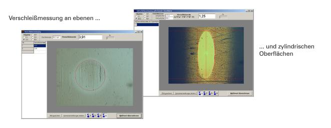
Option 1 für kaloMAX NT Zusätzlich Bestimmung von Verschleißkoeffizienten aus der Vermessung von Kalotten auf ebenen Flächen Option 2 für kaloMAX NT Zusätzlich Bestimmung von Verschleißkoeffizienten aus der Vermessung von Kalotten auf ebenen und zylindrischen Flächen
