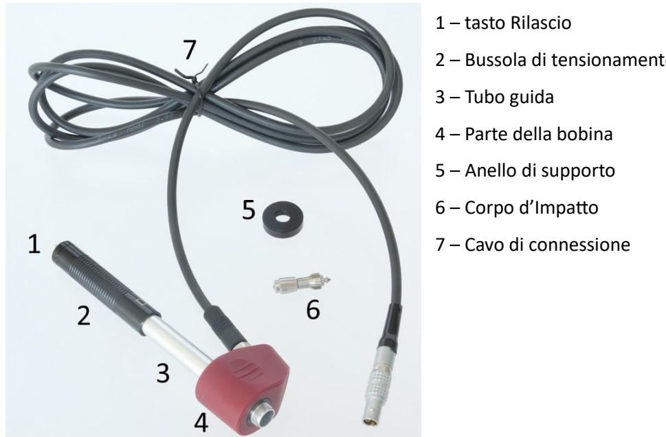
*Figura 12: Componenti del dispositivo d'impatto tipo D*
