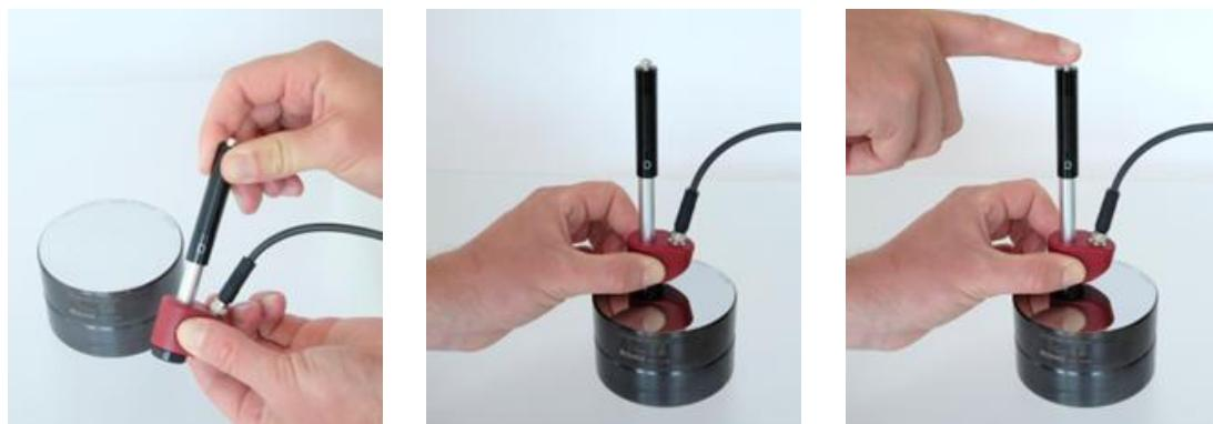
*Figura 13: Esame con dispositivo d'impatto di tipo D*
