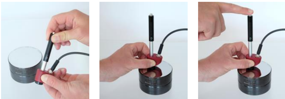
Illustration 13: Mesure à l'aide du dispositif d'impact D
