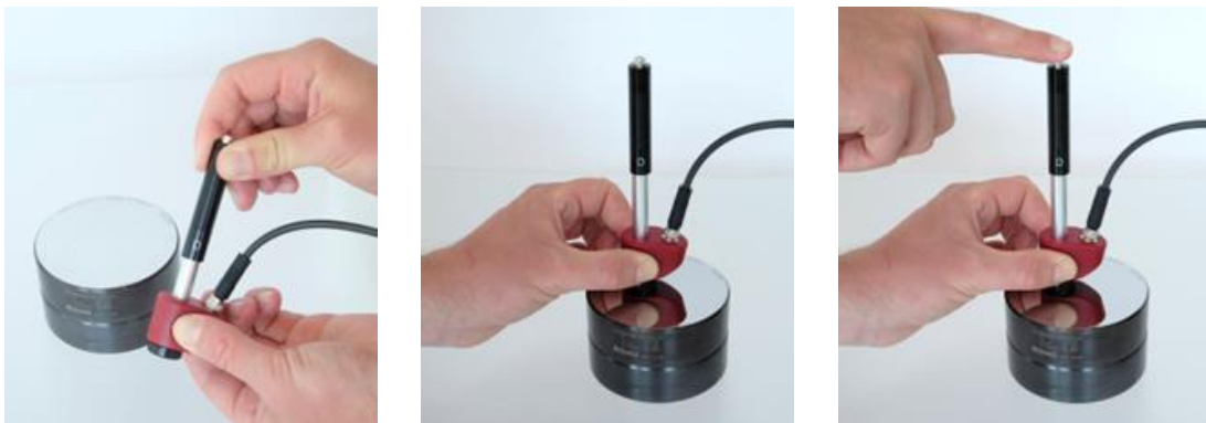
Abbildung 13: Messung mit einem Schlaggerät D
