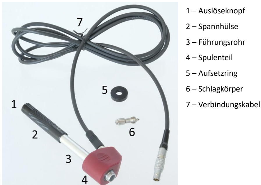
Abbildung 12: Bestandteile Schlaggerät D
